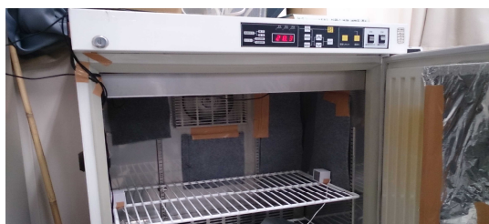
図8 実験に使用したインキュベーター
