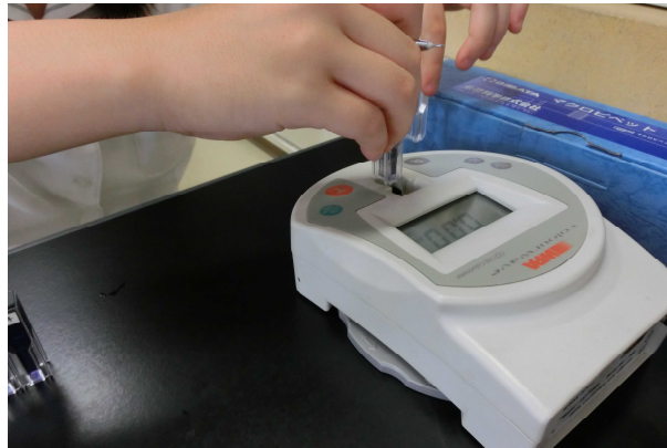
図6 吸光度計によるヨウ素反応の確認
