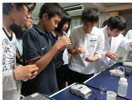
夕食後の講座です。三朝の水と蒜山の水と学校（倉敷）の水の中の塩素濃度を吸光度計やDPD試薬を用いて測定しました。
