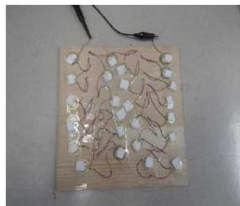
図1 圧電素子による床発電装置
