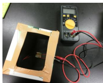
図 5 自作の発光測定装置の実体図と模式図
