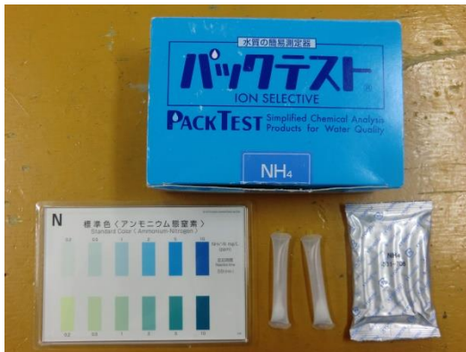
図4 実験に使用したアンモニウムイオン濃度検査薬
