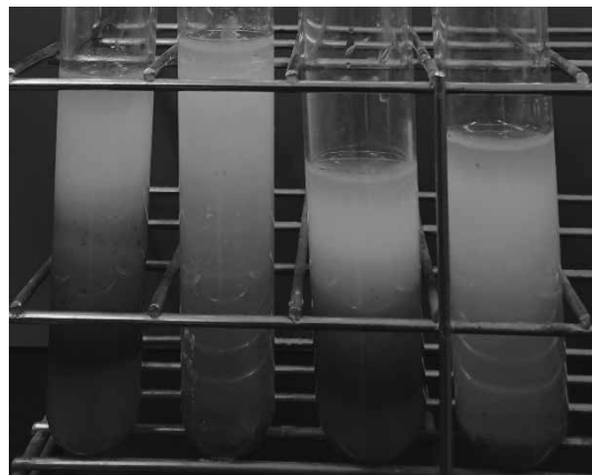
図5 左から 18 mm砂糖, 18 mm食塩, 21 mm砂糖, 21 mm食塩の 20°C, 20 時間後の様子
