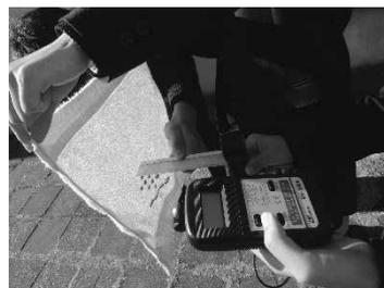
図3 15cm離してタオルを測定
