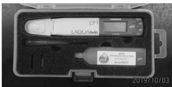
図1 実験に用いた pH 測定器
