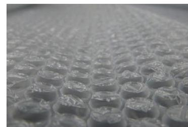
図4 実験に使用した気泡緩衝材
